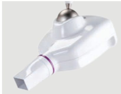
RXDC – tecnología HyperSphere Integrado en el equipo odontológico, el radiográfico y el Pda no necesitan otros puntos de instalación. Óptimo paralelismo gracias a la colimación de 30 cm que, asociado al enfoque de 0,4 mm, garantiza excelentes imágenes. Tocando las zonas touch-sensitive, el cabezal se desbloquea y gira libremente alrededor de la junta esférica.
