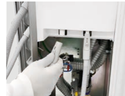
A.C.V.S. Automatisches System, das die Hygieneyklen des Absaugsystems zwischen zwei Patienten ausführt. Praktisch und schnell.
