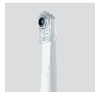
Macro Cap Als äußerst nützliches Zubehörteil bietet die Macro Cap bis 100-fache Vergrößerungen in sehr hoher Auflösung. Durch 3 zusätzliche hochreine Glaslinsen optimiert sie die Beleuchtung von nahe an der Optikgruppe liegenden Details.
