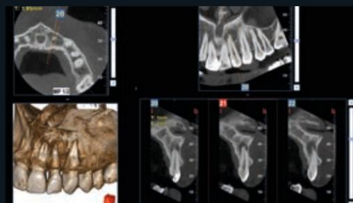
L'esclusiva modalità XF (eXtra Functions\*) sfrutta innovativi protocolli di acquisizione che permettono di raggiungere l'eccezionale risoluzione di 68 µm: la più alta disponibile sul mercato. L'ideale per catturare ogni dettaglio, specialmente nelle applicazioni endodontiche e in quelle per lo studio dell'orecchio. Disponibile anche con FOV 9 x 9 per lo studio della cervicale.
