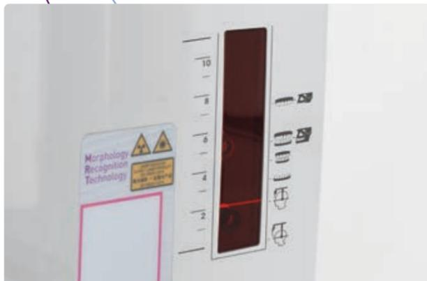
Die Symbole stellen eine nützliche visuelle Referenz dar, um den horizontalen Laser je nach Art der Untersuchung richtig zu positionieren und auf diese Weise die maximale diagnostische Genauigkeit für 2D-, 3D- und CEPH-Bilder zu gewährleisten.
