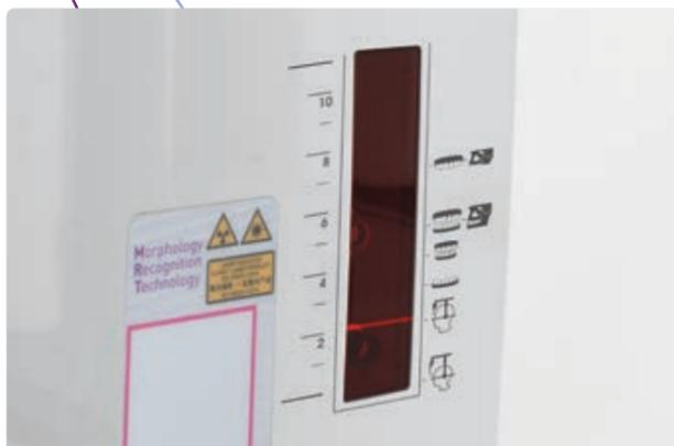
La iconografía suministra una útil referencia visual para el correcto posicionamiento del láser horizontal en función del tipo de examen a fin de garantizar la máxima precisión diagnóstica para imágenes 2D, 3D y CEPH.
