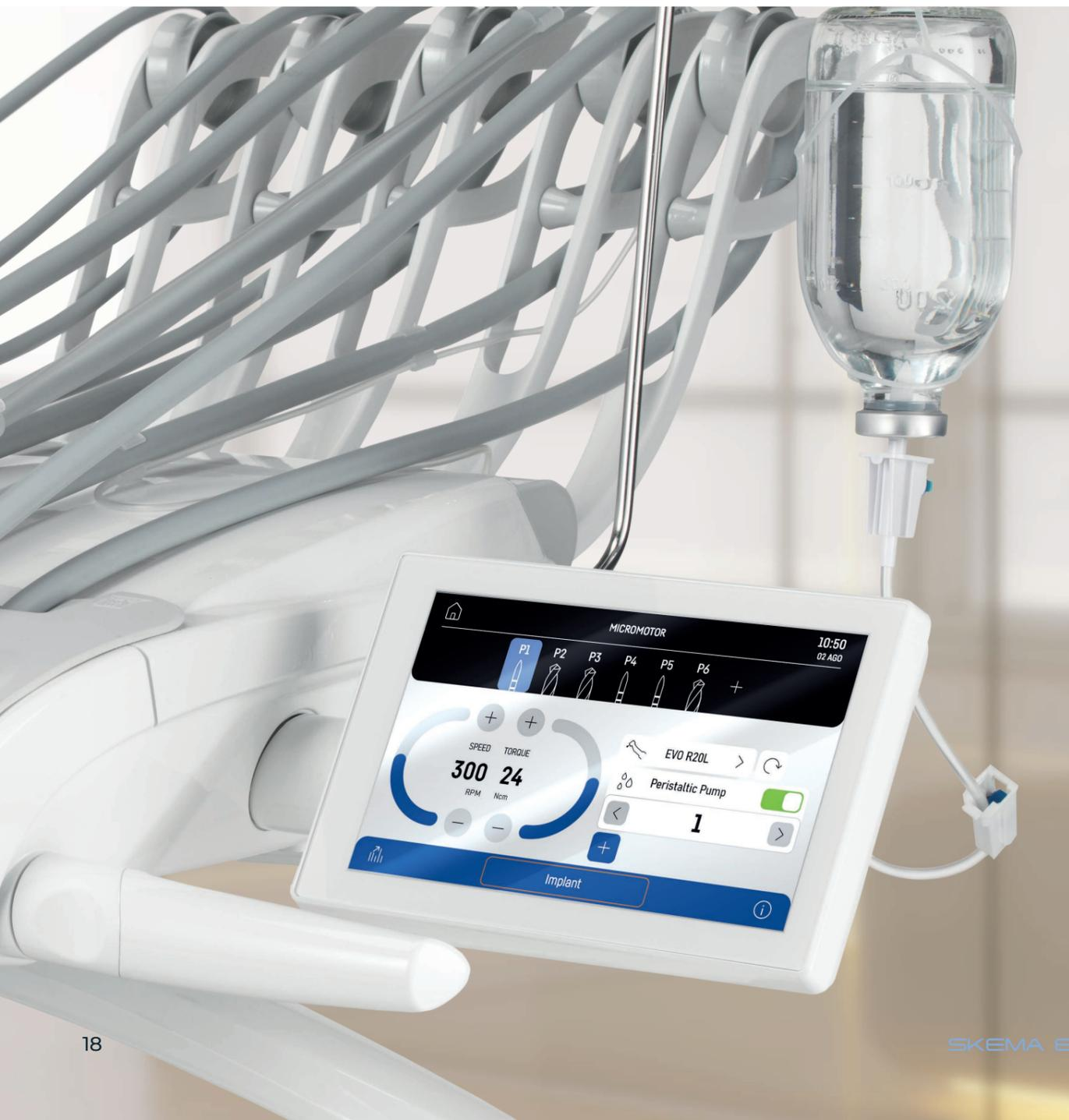
Drehmoment und Durchfluss der Pumpe schnell anpassen und speichern lassen. Der kapazitive 7-Zoll-Multitouch-Bildschirm ist stoß- und wasserfest und mit Multimedia-Inhalten kompatibel. Es besteht die Möglichkeit, die Benutzeroberfläche anzupassen und verschiedene Benutzerprofile auf derselben Behandlungseinheit zu speichern, indem die entsprechend personalisierten Einstellungen auch auf USB-Stick gespeichert werden.
