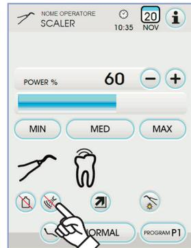
**Selezione della modalità di funzionamento del detartatore.**
