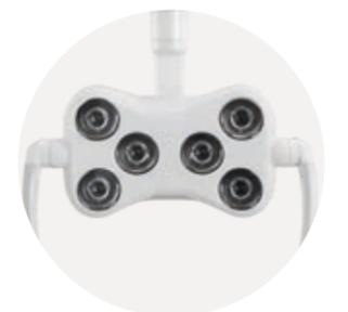
**Venus Plus SCT Composite.** LED-Lampe mit 4 Lichtquellen, die sich außerhalb des Leuchtkörpers befinden, erzeugen einen großen Lichtspot und minimieren die Schattenbildung. Die 2 zentralen Lichtquellen erzeugen einen Lichtstrahl mit verschiedenen Wellenlängen, die eine Vorpolymerisation der Komposite verhindern.
