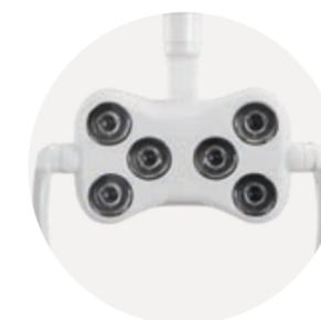
**Venus Plus SCT Composite.** Éclairage à LED équipé de 4 sources lumineuses, placées à l'extérieur du corps de l'éclairage et à qui créent un grand spot, ce qui permet de minimiser la génération d'ombres. Les 2 sources lumineuses centrales génèrent un faisceau lumineux avec des longueurs d'onde spécifiques, qui empêchent la pré-polymérisation des composites.
