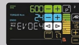
**Endodontie.** In diesem Modus optimiert das optionale System für die integrierte Endodontie die Ergonomie der Wurzelkanalbehandlungen. Es umfasst einen Mikromotor, die Autostop-, Autoreverse- und Autoforward-Funktionen sowie einen elektronischen Apexlokalisator. Während der endodontischen Behandlung
