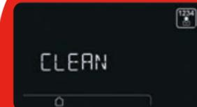
**Clean.** Funktion, die den Betrieb des Bedienfeldes während der Reinigung der Glasfläche der Bedienkonsole unterbindet, um ein unbeabsichtigtes Betätigen der Bedienelemente zu vermeiden.
