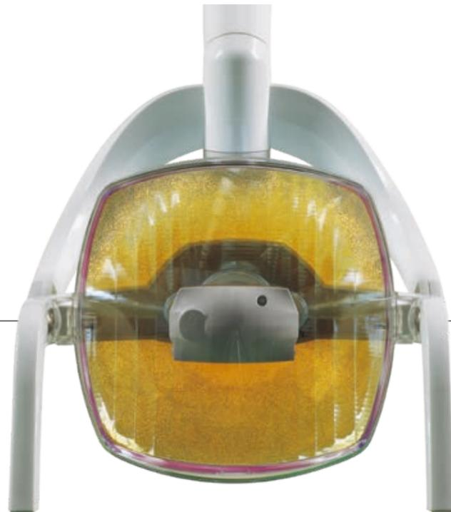
**Potenziometro integrato.** Fornita di serie, la lampada alogena Venus Plus si accende con dispositivo soft-start e ha una temperatura di colore di 4900K. L'intensità luminosa, che va da 8.000 fino a 35.000 Lux, è regolabile tramite potenziometro.
