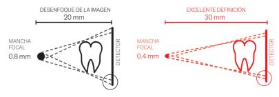
El aumento del paralelismo de los rayos X y el colimador incorporado permiten a RXDC alcanzar una distancia entre objetivo y piel de 30 cm. Con RXDC obtienes imágenes nítidas y precisas con un alto nivel de detalle.
