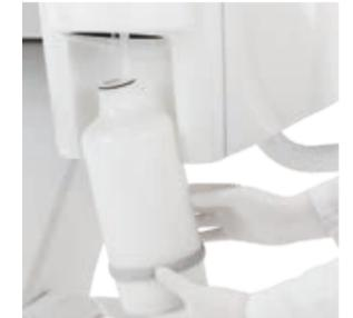
**S.H.S.** Vorrichtung für die Sprayversorgung als Alternative zum Wassernetz. Funktioniert mit einem mit destilliertem Wasser gefüllten Tank. Äußerst nützlich bei besonders hartem Leitungswasser.
