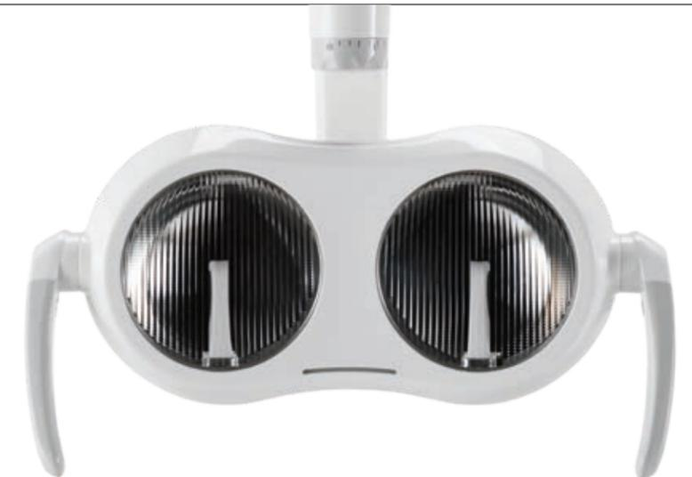
**Venus LED MCT (Multi Colour Temperature).** Optionale Lampe der jüngsten Generation für die Nutzung von 3 verschiedenen Farbtemperaturwerten: 4300 K (Warmlicht) für chirurgische Behandlungen, 5000 K (neutrales Licht) für die konservierende Behandlung und 5500 K (Kaltlicht) für die Farbmessung. Die **Curing Mode**-Funktion verändert die Wellenlänge des Lichts, um einer Vorpolymerisation der Komposite vorzubeugen und zugleich eine optimale Beleuchtung sicherzustellen.
