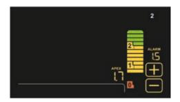
Localizador apical. Durante la instrumentación del canal radicular, el display LCD muestra la distancia desde el ápice. La aproximación al ápice es verificada por el software ENDO y, al alcanzarlo, la función Apex-Stop interrumpe la rotación del micromotor.
